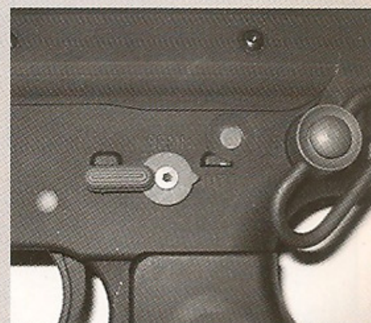
全自動射擊模式 Full-Auto Mode 扣住扳機不放，子彈會連續發射。
