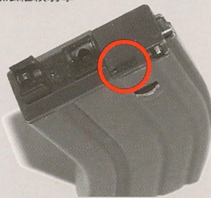
防掛機ON，子彈打完槍機不會固定，可繼續打空槍直到瓦斯用罄。
