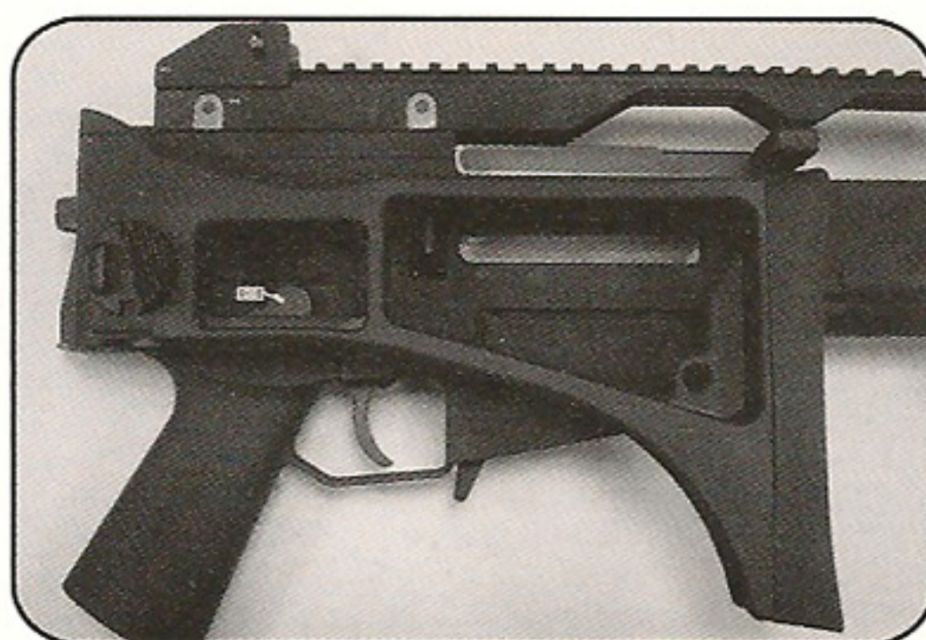
按壓槍托摺疊鈕, 即可將槍托摺疊至定位
