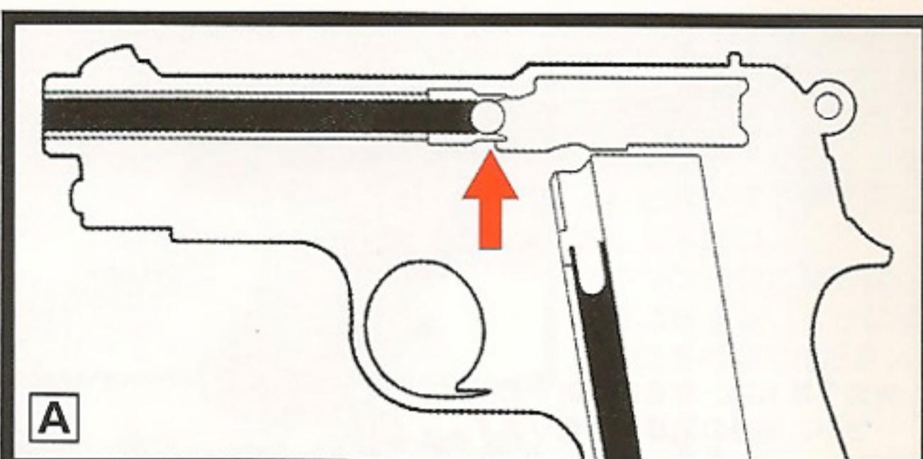
銃身後部のラバー・チャンバー(図A矢印部分)は消耗品です。発射の際のBB弾の飛距離が短くなったらラバー・チャンバーの交換時期です。次の手順にしたがって交換してください。
