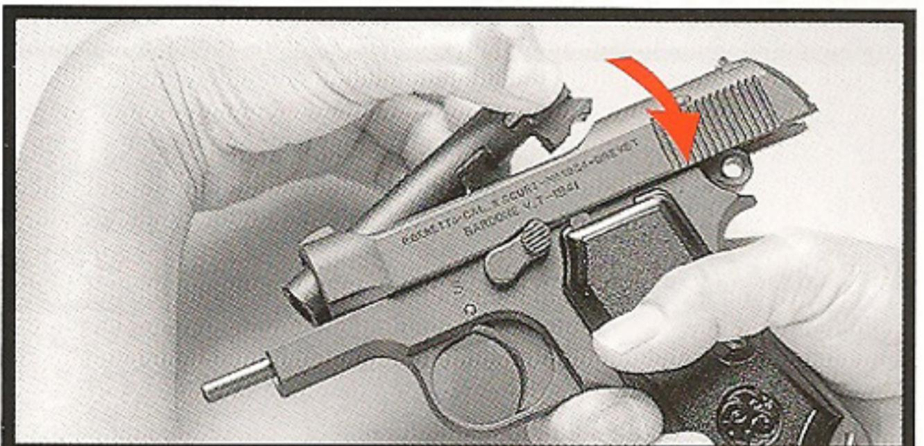
バレル・アッセンブリーは、まずスライド天面くりぬきに斜め後から差し込みます。続いて水平状態にしてから、フレームの内側のレールに合わせ、前方に一杯まで押し込んでください。
