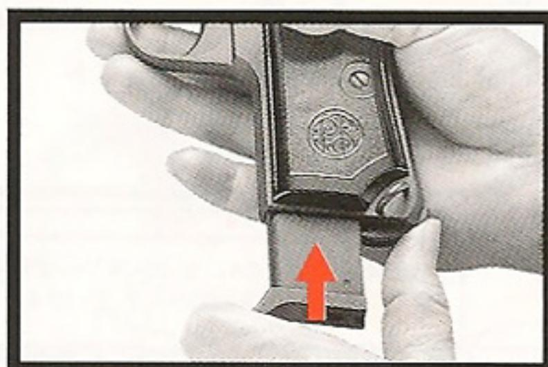
マガジン・キャッチを押しながら、マガジンを銃本体に戻します。マガジン・キャッチから「カチッ」と音がするまで押し込んで下さい。マガジンと銃本体の間に手をはさまないように十分に気を付けて下さい。
