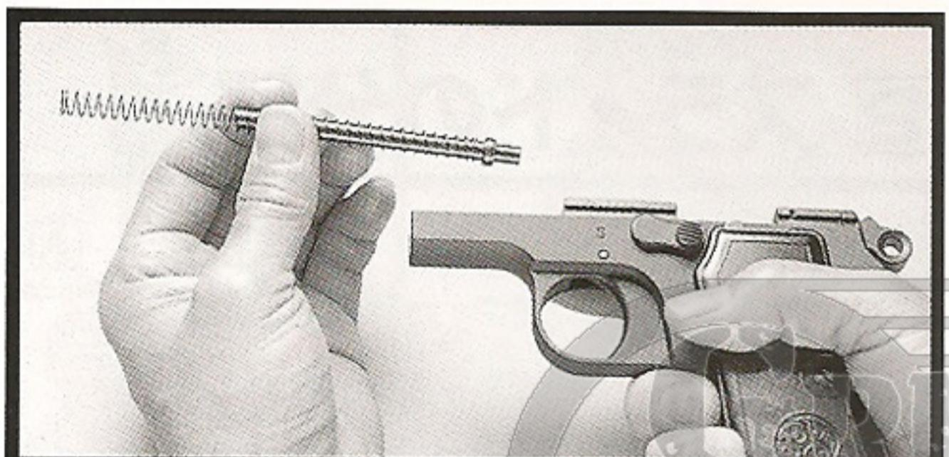
フレームからリコイル・スプリングとリコイル・スプリング・ガイドを抜き取り、フィールドストリッピングは完了です。
