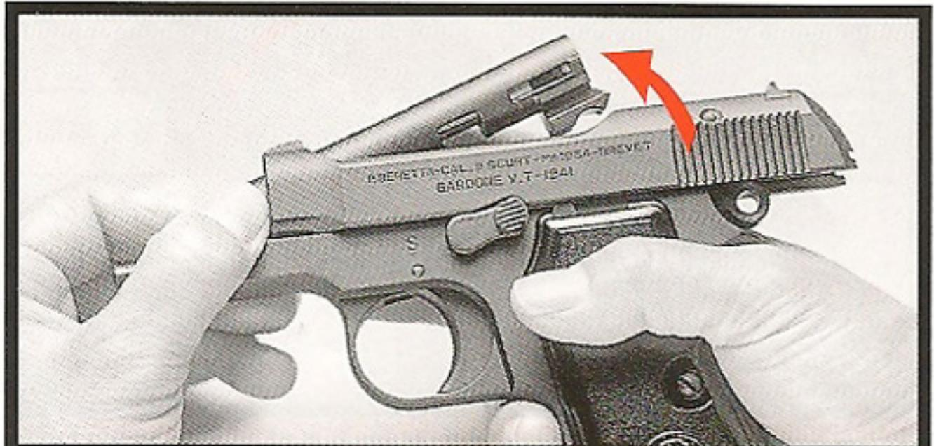
そのままバレル先端を下方に押し付けてから、バレルを斜め上方に引き抜いてください。
