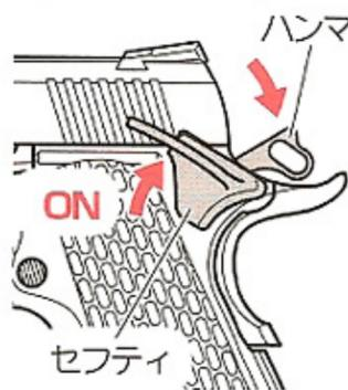
左図のハンマーが「フルコック」位置の時のみ、セフティを操作して、ONの状態に出来ます。また、この状態ではトリガーとスライドが操作できません。破損の原因となりますので、無理に動かさないでください。
