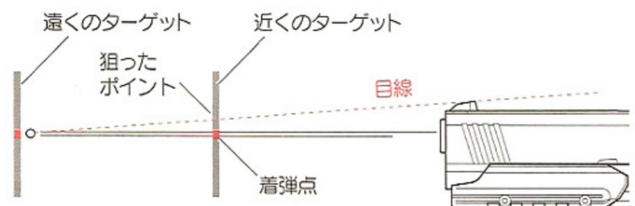
※ターゲットまでの距離が7m未満の場合、左図の通りにサイティングしても狙いより下に着弾します。この製品の特性上、フロント/リアサイトに着弾点の調節機能はありませんので、着弾点が下がっている場合はターゲットの上を狙うようにしてください。
