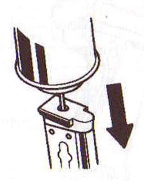
PLACE THE MAGAZINE UPSIDE DOWN, THEN FILL THE GAS BOTTLE TO THE MAGAZINE IN VERTICAL DIRECTION.
