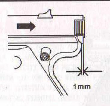
PUSH THE BARREL/RECEIVER BACKWARD ABOUT 1mm.
