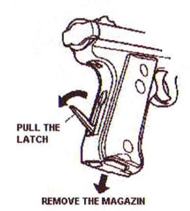
REMOVE THE MAGAZINE AND PULL THE LATCH LEVER OUT TOWARD THR REAR.
