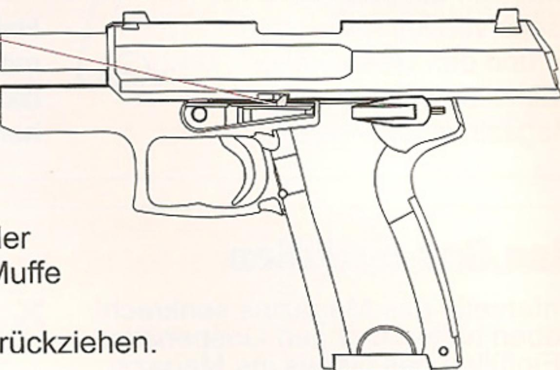
Zum erstmaligen Abschießen der ersten Kugelladung muss die Muffe in die Position zum Laden der BB-Kugeln für den Auslöser zurückziehen.
