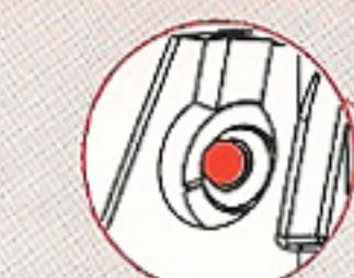
Nach dem Einfüllen des Gases darf nicht auf das Gasventil gedrückt werden. Die Haut oder die Augen des Benutzers kann durch die überraschend niedrige Temperatur des Gases verletzt werden.
