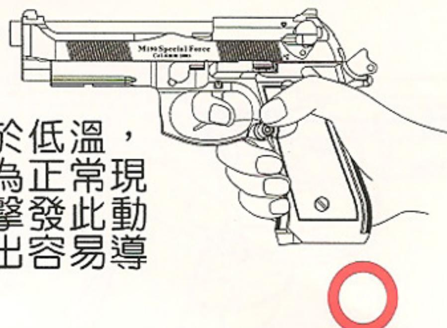
■長時間連續發射容易使彈匣過於低溫，影響氣體壓力及子彈初速，此為正常現象非故障所致。擊發時請勿倒轉擊發此動作無法使氣體揮發產生霧氣噴出容易導致零件耗損。
